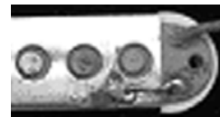
Abb. 5.4.35: Fender-Jaguar-Tonabnehmer [www.guitar-parts.com, www.jimshine.com]; die gezahnte U-Schiene (engl. "claw") leitet einen Teil des von der Saite rückfließenden Magnetflusses zum Südpol zurück.
