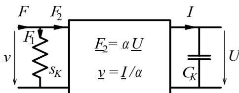
**Abb. 6.1:** Ersatzschaltbild des Piezowandlers. Die antreibende Kraft  $\underline{F}$  teilt sich in  $\underline{F}_1$  und  $\underline{F}_2$ .
