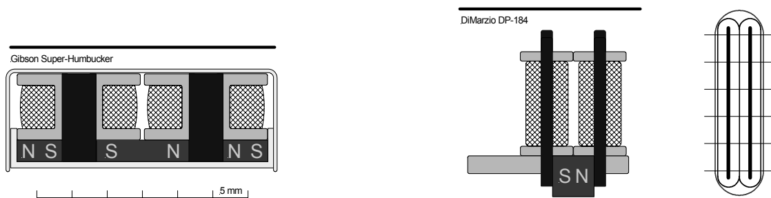
Abb. 5.2.3: Gibson 'Super'-Humbucker [nach Lemme] mit drei Magneten, und DiMarzio-Humbucker mit zwei Metall-Klingen. Der in der L6S verbaute Super-Humbucker hatte allerdings Koaxialschichten [Billlawrence.com].
