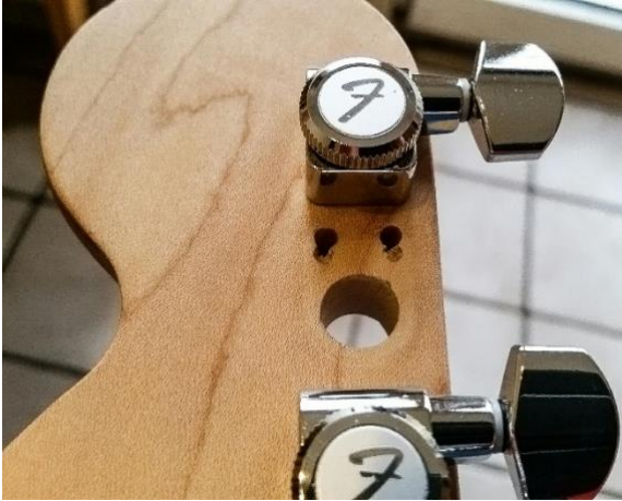
Direkt über den vorhandenen Löchern werden 2 neue gebohrt
